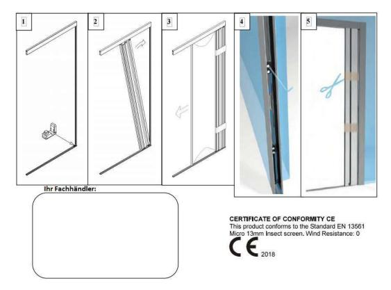
Bitte beachten Sie, dass der Anschlagmagnet im Wandprofil immer nur punktuell im Profil fest ist, damit Sie bei Bedarf leichter an die dahinterliegenden Fadenspanner kommen. Nach fertiggestellter Montage muss der Magnet endgültig befestigt werden.
